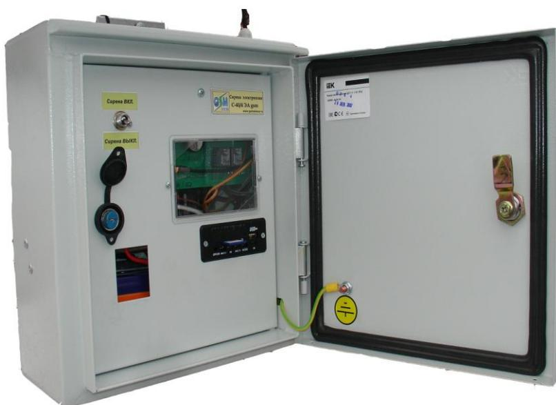
Сирена электронная С-40/4 ЭА gsm выполнена в металлическом ящике (IP54). На внутренней дверце расположен тумблер принудительного включения-отключения сирены. Подвод кабелей снизу ящика через гермовводы.
